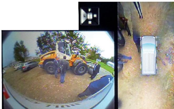
Bild 13. Monitoransicht eines 360°-KMS [14]
