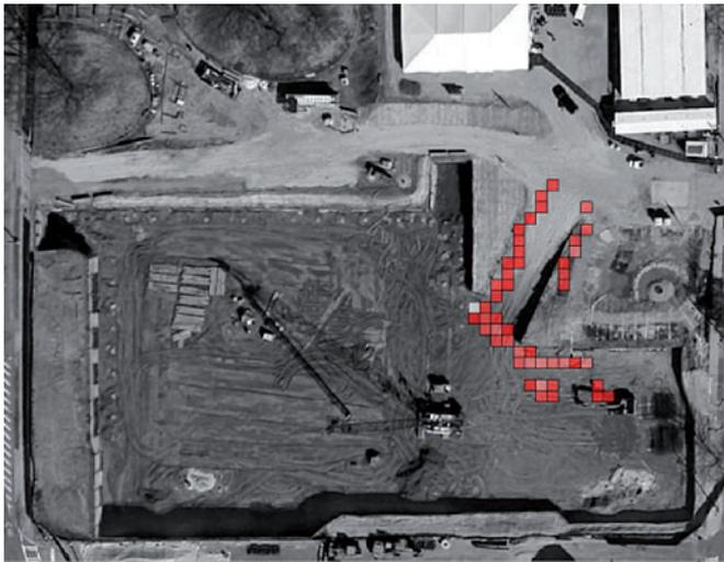
Bild 18. Drohnenbild mit überlagerter Heatmap zum Aufzeigen von Beinahe-Unfällen zwischen Baumaschinen und Personen am Boden im Bereich der Rampe einer Baugrube [28]
