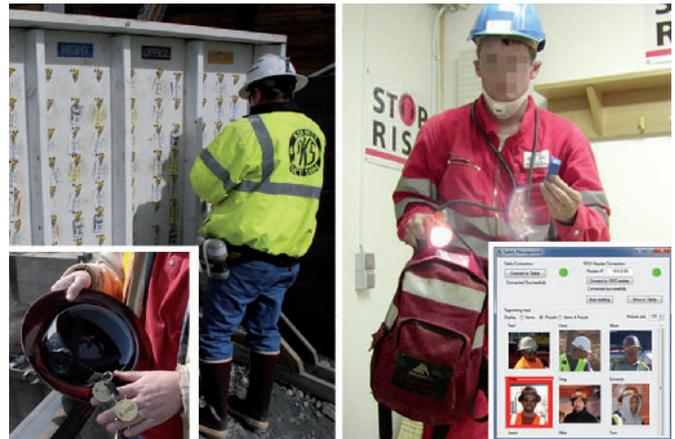
Bild 7. Manuelle „Tag-In Tag-Out“ Tafel (links) und elektronisches RFID-System (rechts) zur Personenerfassung und Zugangskontrolle
